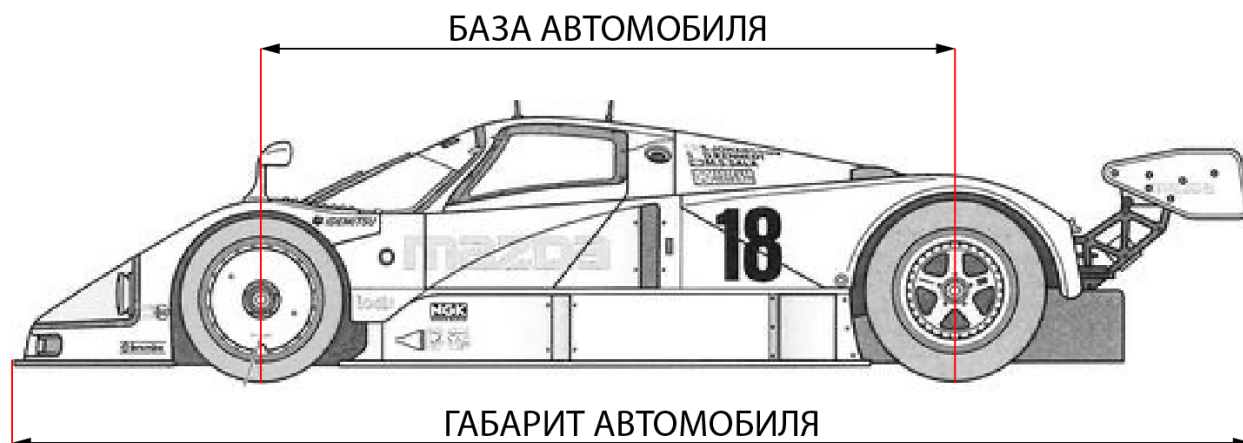
Рисунок 1 Обозначение базы и габарита автомобиля
