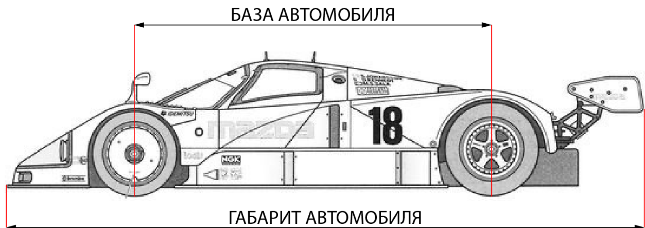
Рисунок 1 Обозначение базы и габарита автомобиля
